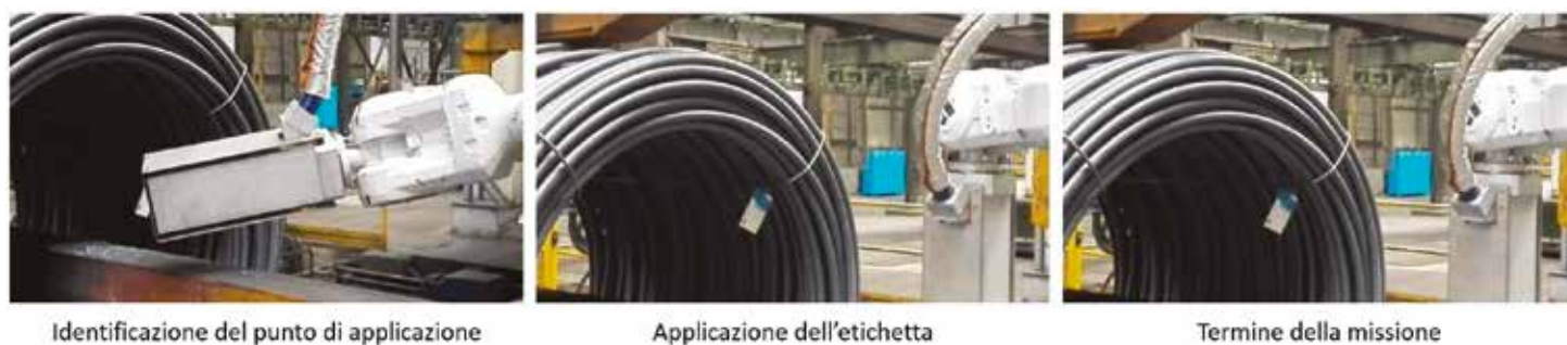
Figure 4 - Fasi di etichettatura robotizzata di un rotolo di vergella
