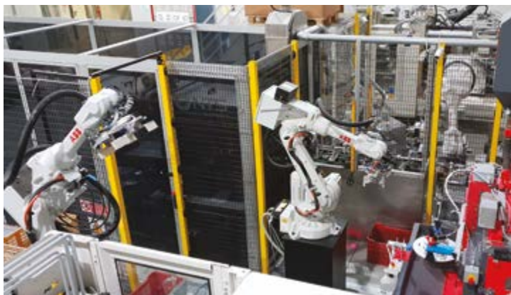
Sistema automatizzato per la gestione dello stampaggio a iniezione e delle successive fasi di lavoro
