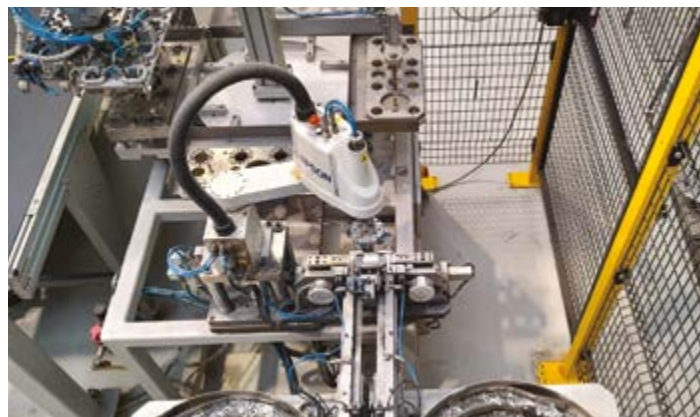
Sistema di singolarizzazione con robot scara
